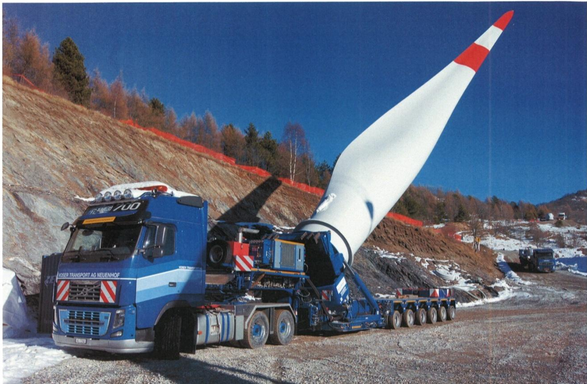
Abb. 4-2: Spezialtransporter für Rotorblätter von Windenergieanlagen (2)
